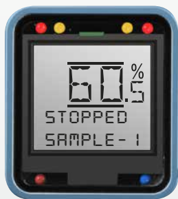
Индикация положения арматуры
